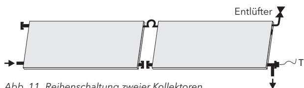
Abb. 11 Reihenschaltung zweier Kollektoren.
